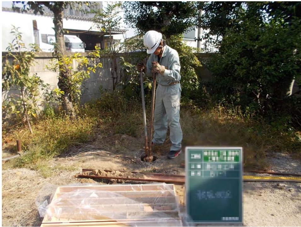
図 4-11 手掘りによる試料採取状況の例(ダブルスコップを使用)
